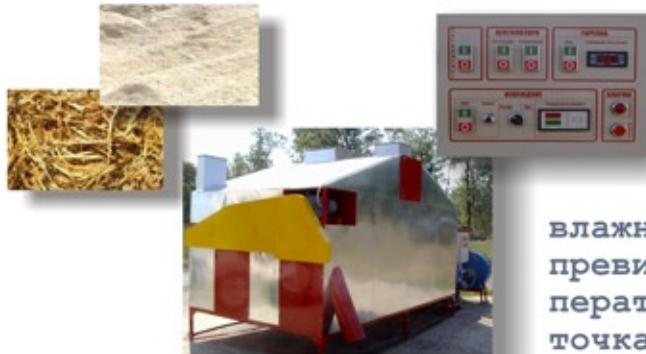
Входният влажен материал постъпва в приемното устройство на машината и започва да се движи в сушилната камера посредством витки, чиято скорост се регулира електронно в зависимост от желаната крайна влажност. Едновременно с това се следи и за превишаване на предварително зададена температурна граница от противопожарна гледна точка.
